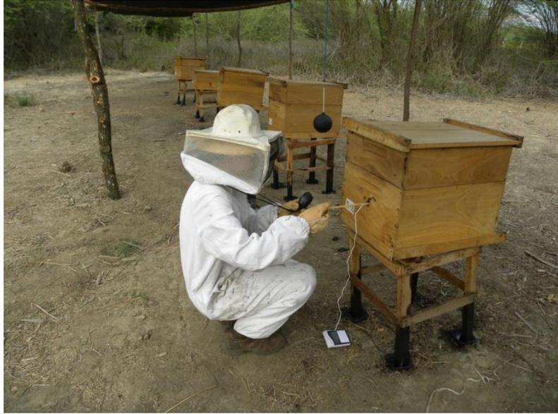
**Figura 7.** Introdução do sensor do termohigrômetro no centro do ninho para coleta da temperatura e umidade interna.
