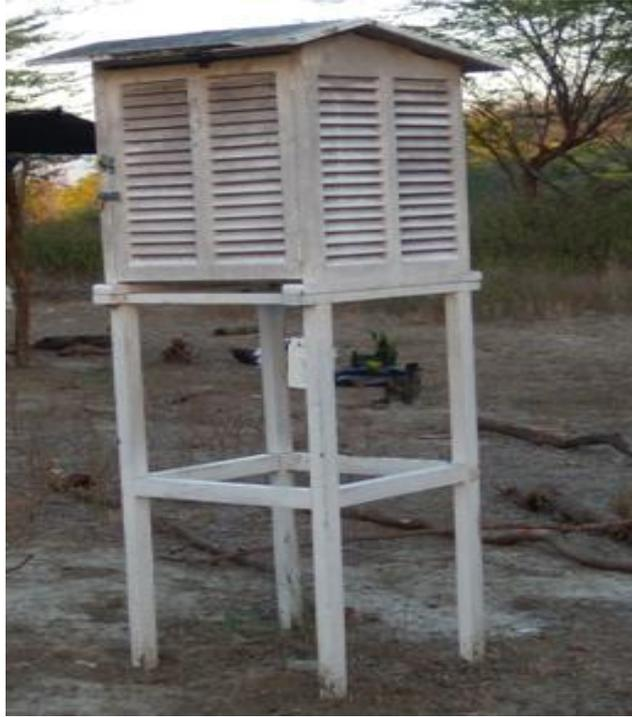
**Figura 5.** Abrigo termométrico.
