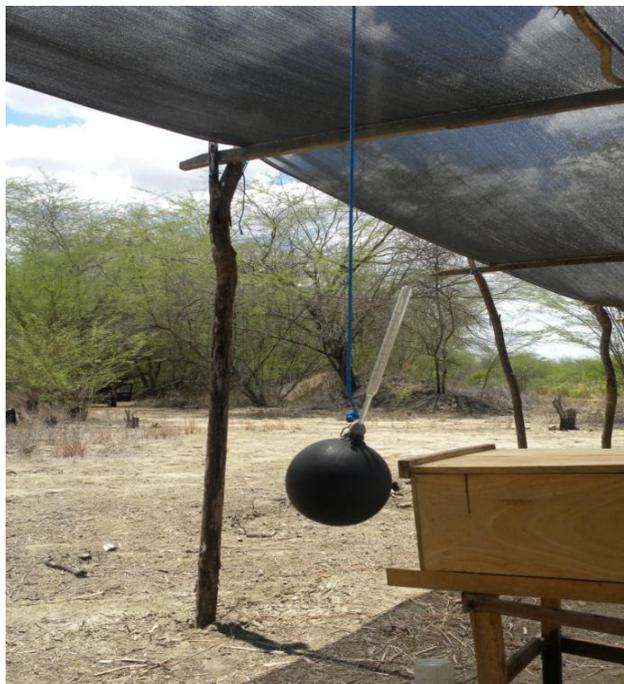
**Figura 6.** Globo negro instalado a 0,8 metros do piso.
